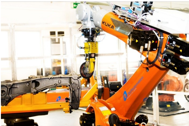
Anlage zum roboterbasierten Nachbearbeiten von Gussteilen mit vorgelagerter Konturerkennung
