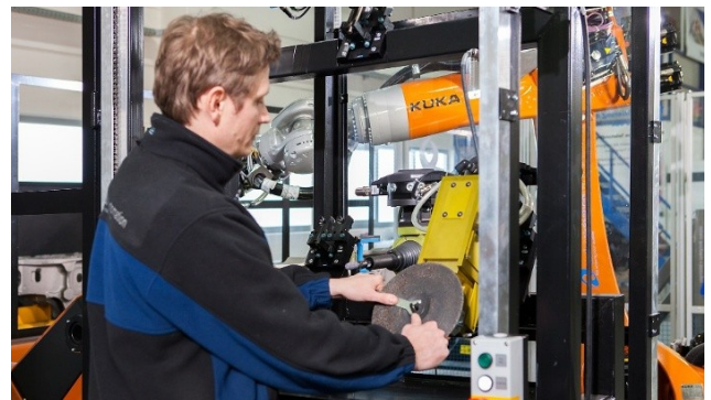
Werkzeugwechselsystem - Sicherer Wechsel des Verschleißmaterials während des laufendem Betriebs
